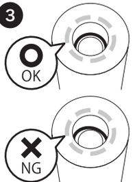
ずれていないことを確認し、タンクを閉めます。ずれているとパッキンの破損や水漏れの原因となりますのでご注意ください。
